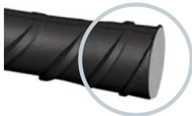
Специалисты компании Ancon уже давно выяснили, что для ограничения параметра деформативности каждый откованный стержень после нарезки резьбы должен пройти операцию снятия внутренних напряжений. Без этой операции параметр деформативности муфтового соединения, например, 40 Ø будет составлять примерно 0,3 мм, что приведет к поверхностным трещинам в бетоне, равным почти 1 мм.
