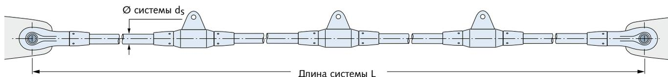
Пример заказа: (материал – сталь): система связей, DETAN S460,  $d_s = 30$  мм,  $L = 34000$  мм, 3 муфты с подвесной петлей.
