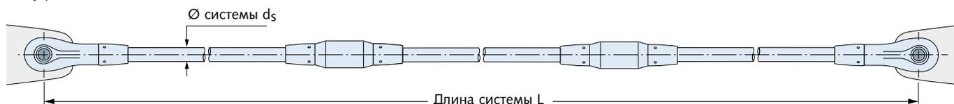
Пример заказа: (материал - сталь): система связей, DETAN-E,  $d_s = 24$  мм,  $L = 11200$  мм, 2 муфты.
