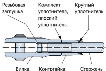
Все типовые вилки поставляются с резьбовой заглушкой, которая устанавливается на конце резьбы. Цветная маркировка облегчает распознавание резьбы: желтый цвет – правая резьба, голубой цвет – левая резьба. Дополнительную защиту создает специальная система уплотнителей, которая стандартно присутствует во всех размерах типовых конструкций, начиная с диаметра  $\varnothing 16$  мм.
