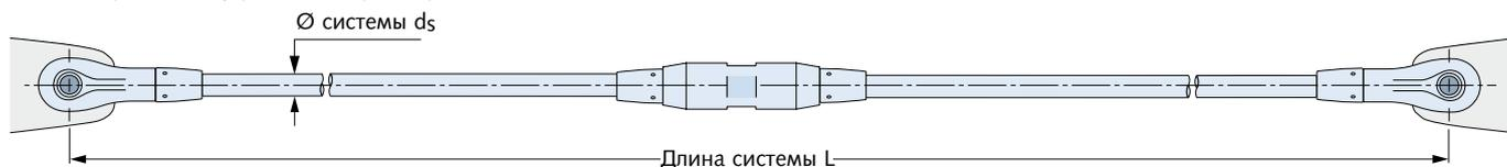
Пример заказа (материал - сталь): система натяжных стержней, DETAN -S460, диаметр системы,  $d_s = 30$  мм, длина системы,  $L = 5600$  мм, обработка - горячая оцинковка, 1 шестигранная муфта.
