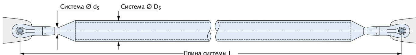
Пример заказа: Системы стержней, работающих на сжатие DETAN-S355, диаметр системы  $D_s = 42$  мм, длина системы  $L = 2000$  мм, диаметр вилочной головки  $d_s = 16$  мм.
