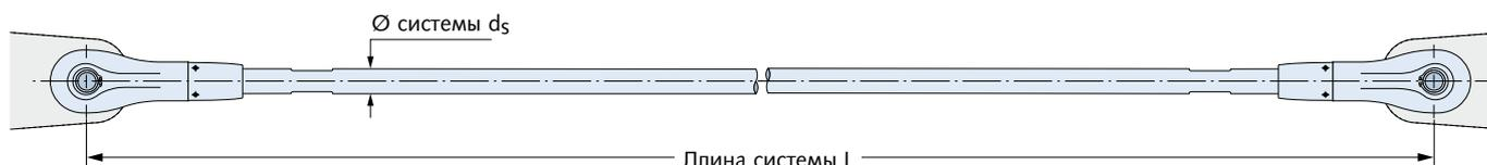
Пример заказа (материал - сталь): система связей, DETAN-S460,  $d_s = 52$  мм ,  $L = 3620$  мм.
