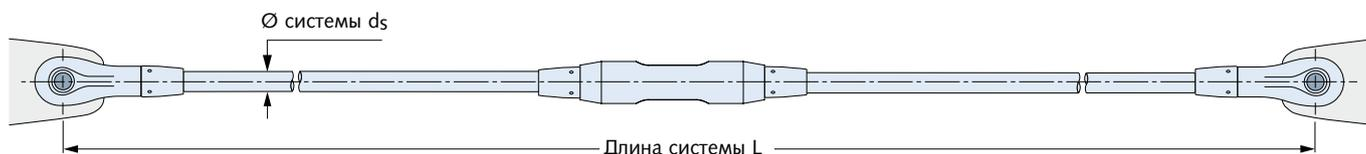
Пример заказа (материал – сталь): система натяжных стержней, DETAN S460,  $d_s = 300$  мм,  $L = 5600$  мм, 1 перекрестная муфта.
