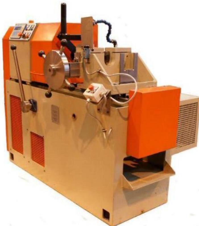
*Рисунок Е.1. Машина для нарезки цилиндрической резьбы CXL ABP TS200.*
