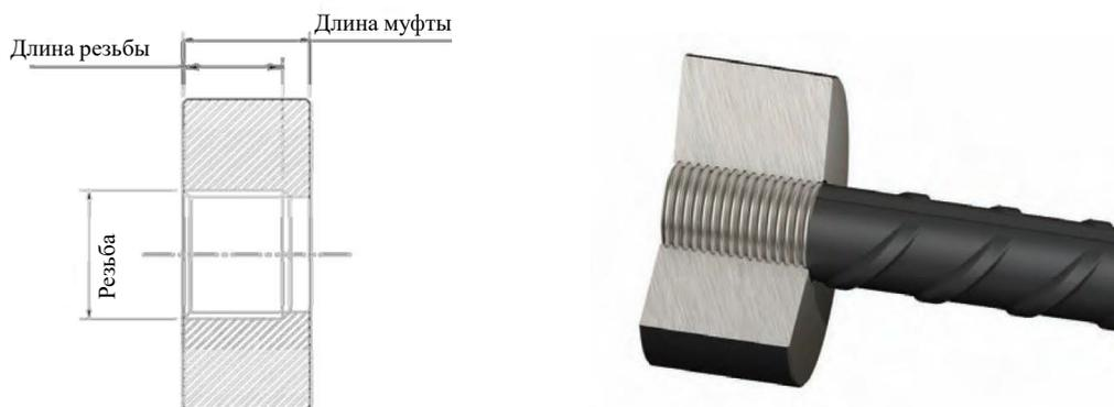
Рисунок 6.4. Анкерное соединение Ancon RT.
