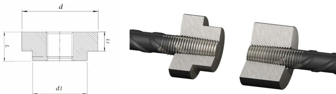
Рисунок 4.6. Анкерное механическое соединение Ancon ТТН.
