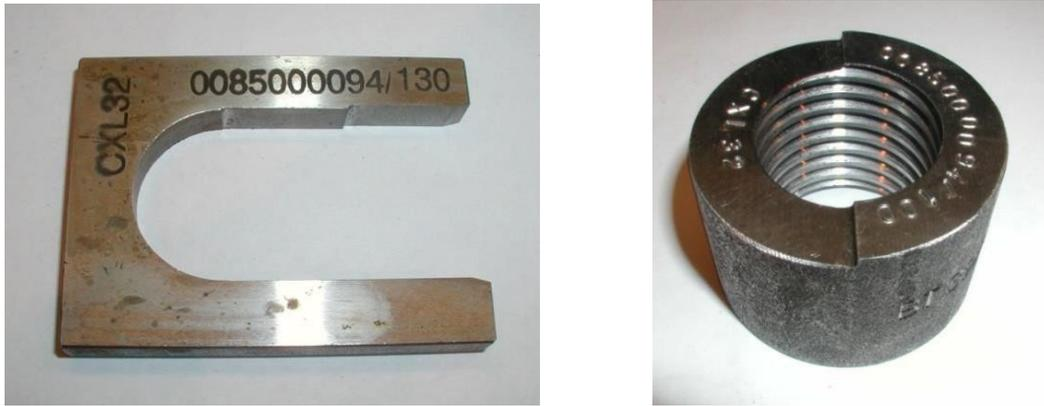
Рисунок С.6. Калибры диаметра и длины несущей резьбы CXL.
