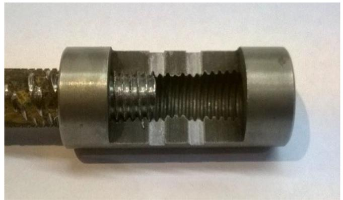
Рисунок С.8. Калибр длины конической резьбы Ancon TT.
