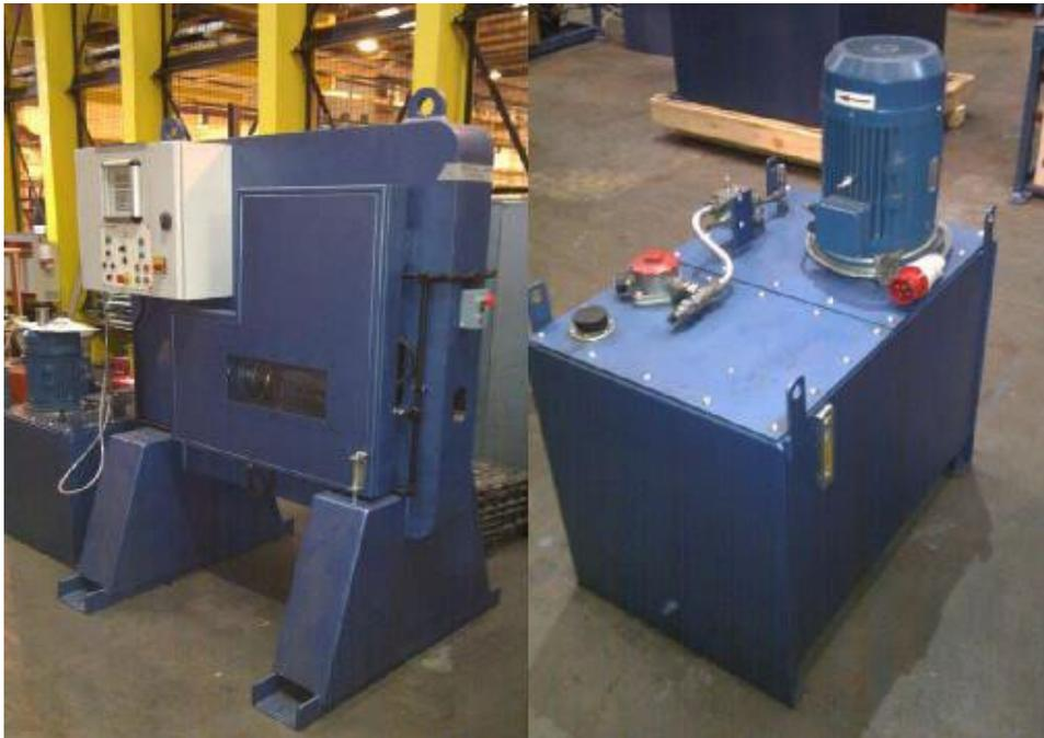
Рисунок D.1. Ковочная машина АВРСF с блоком электрического насоса.
