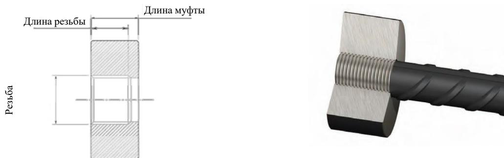
Рисунок 5.4.1. Анкерное соединение CXL H.
